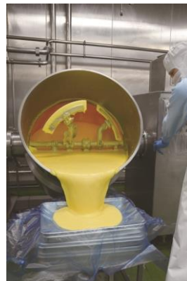
銅釜で炊いたカスタードは少量ずつ バットに入れて冷却して商品に使用
