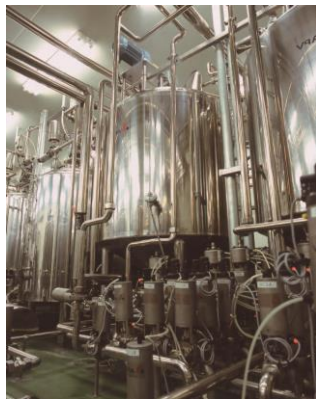
各自社工場内にあるミルクプラント。 パイプで各製造ラインへ送られる
